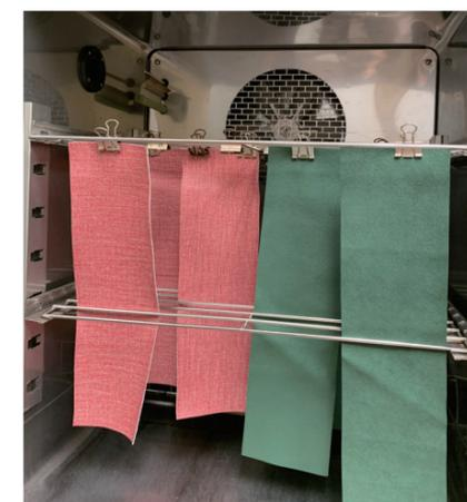
試験片は、恒温器で24時間、一定の温度と湿度の環境に置かれ、公定水分率に近い状態で各種試験が行われます。殆どの物質は、温度と湿度の影響を受ける為です。
