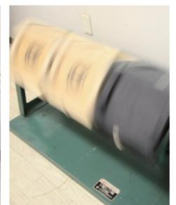
コルクで囲われた箱の中に入れられ、10時間回転させて、毛玉が発生する度合を測ります。糸の形状にもよりますが、糸の強度が必要以上に強すぎると、毛玉の発生につながります。糸の力よりも、組織のバランスで強度を保つように設計するのが、椅子張りの特徴です。
