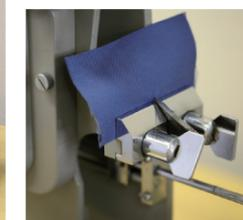
試験片に切り込みを入れ、重量と加速度をかけて引裂きます。引裂くために必要な力を記録します。薄い物は弱い傾向がありますが、糸の太さや糸の本数を変更することで、少しでも強度が上がるように工夫しています。
