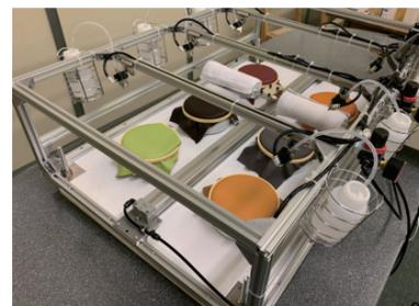
標準法が存在しない為、IDC株とシンコー株にて、準耐アルコール試験法を開発(特許第6265492号取得済み)し、業界へオープンにして標準化しています。そのアナログ方法を、新設計の試験機で再現して、大量に試験を行っています。この試験機の販売も行っております。定義された濃度のアルコールを500回と1000回の噴きかけ及びふき取りを繰り返して、レザーの硬化を確認します。
