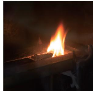
燃え広がるスピードと燃焼跡の長さを測ります。燃え広がる速度が少しでも遅くなることで、人命の安全を確保するのです。
