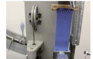
縫い目やタッカーの打込みによる糸抜けが無いが確認します。この数値が弱くても、ミシンの精度や調整で大分カバーできるのですが、安定度を管理するためにも用います。また、試作中に縦横の強度バランスを見るのにも適しており使用します。
