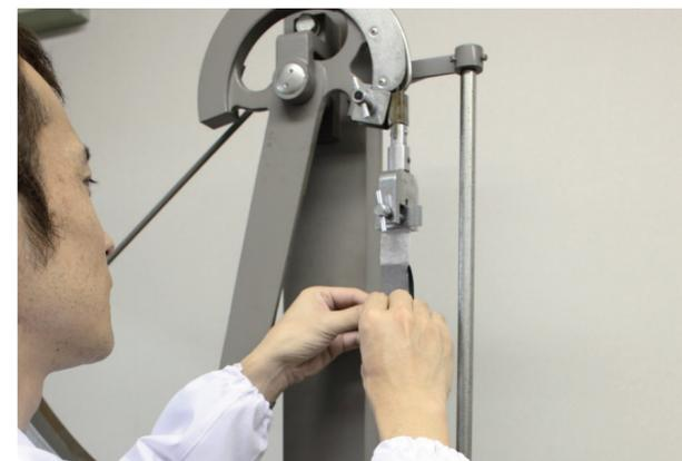
レザー基布とPVC部分が剥離しないよう、椅子張り用に適した数値管理をしています。海外レザーでは、初期の数値と使用中の数値低下(劣化)が大きいケースで、表面の破れに繋がっていますが、私共では、これをノウハウで防ぎます。また、ファブウェル®のフィルムと接着強度も試験しています。
