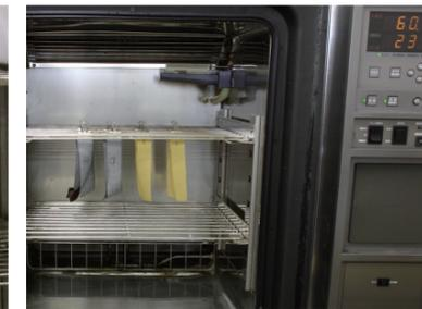
主に海外製ポリウレタン樹脂で問題となる加水分解の促進度を測る試験です。温度70℃、湿度95%という過酷な条件をこの機械でつくり、10週間から20週間放置し、樹脂の劣化を促進させます。その後、各種強度試験をして、試験前後の強度変化を確認します。大型機と中型機で追試を繰り返し、品質保証をしています。近年では、海外製が試験に持ち込まれますが、バラつきが激しく、継続して合格した例はありません。湿度を95%から緩和するなどすると、合格する例もある様ですが、長い目で見て品質保証していると思えませんし、インチキで悪質業者と断定します。
