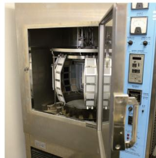
カーボン管に電流を流して紫外線を発光させ、光による色落ちの具合を計測します。フル稼働で試験しています。
